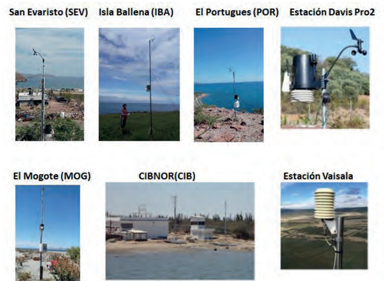
Figura 3. Registro fotográfico de los 5 sitios donde se ubican las EMAs a lo largo de la bahía de La Paz. Las estaciones SEV, POR, IBA Y MOG utilizan estaciones Davis Vantage Pro2 (panel superior derecho) y en CIB una estación Vaisala (panel inferior derecho).
